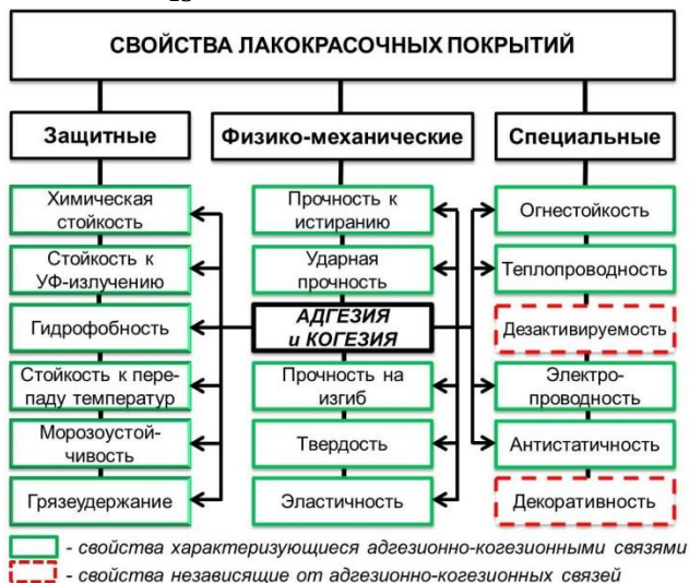
Рисунок 2 – Схема влияния адгезии и когезии на свойства лакокрасочных покрытий
